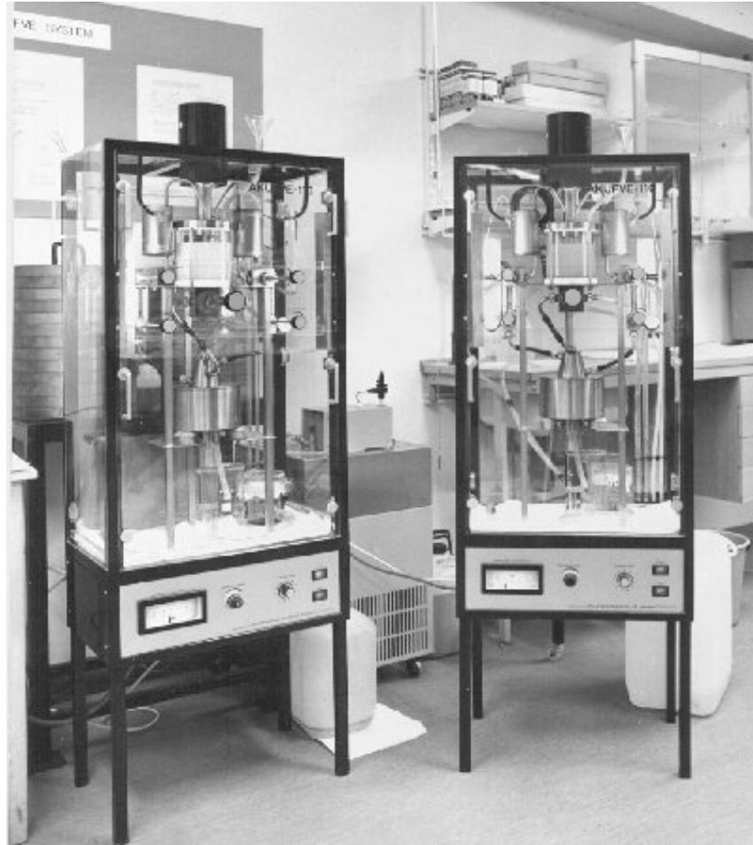
**AKUFVE-110** 的研制开发已有**40**余年历史（此装置目前已售出几百套），是一种理想的单级混合（离心式）澄清装置，用于提高溶剂萃取分布数据测量技术的精度和速度。
